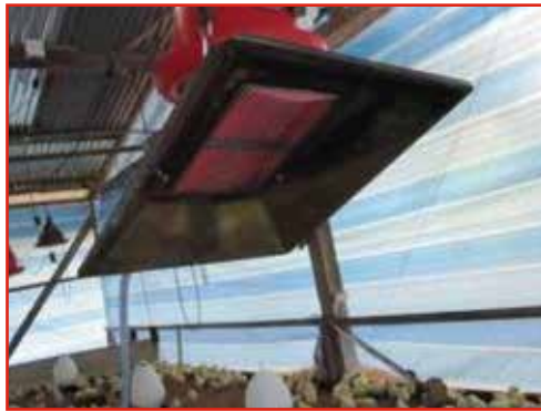
Figura 6: Criadora infrarroja a gas
