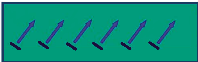
Figura 30: Ventiladores de circulación ubicados para soplar diagonalmente a lo ancho del galpón.
